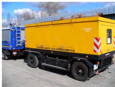
Netzersatzanlage 179 kVA (NEA)
