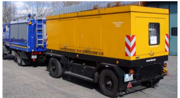
Die große Netzersatzlage mit 179 kVA Nennleistung konnte erst 2007 von den Stadtwerken Augsburg gebraucht übernommen werden. Während Sie sich noch nicht im Katastropheneinsatz bewähren konnte, wurde sie bei Übungen und sonstigen technischen Hilfeleistungen ausprobiert und getestet.
