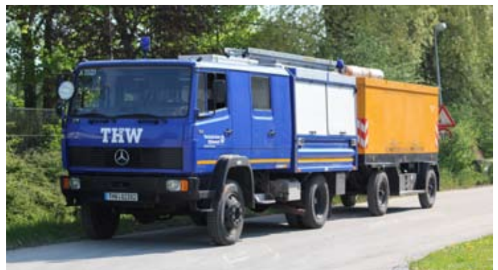
Mannschaftslastwagen MLW3 mit Netzersatzanlage 179 kVA
