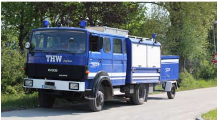
Gerätekraftwagen GWK2 mit Stromerzeuger 30 kVA (1.TZ)
